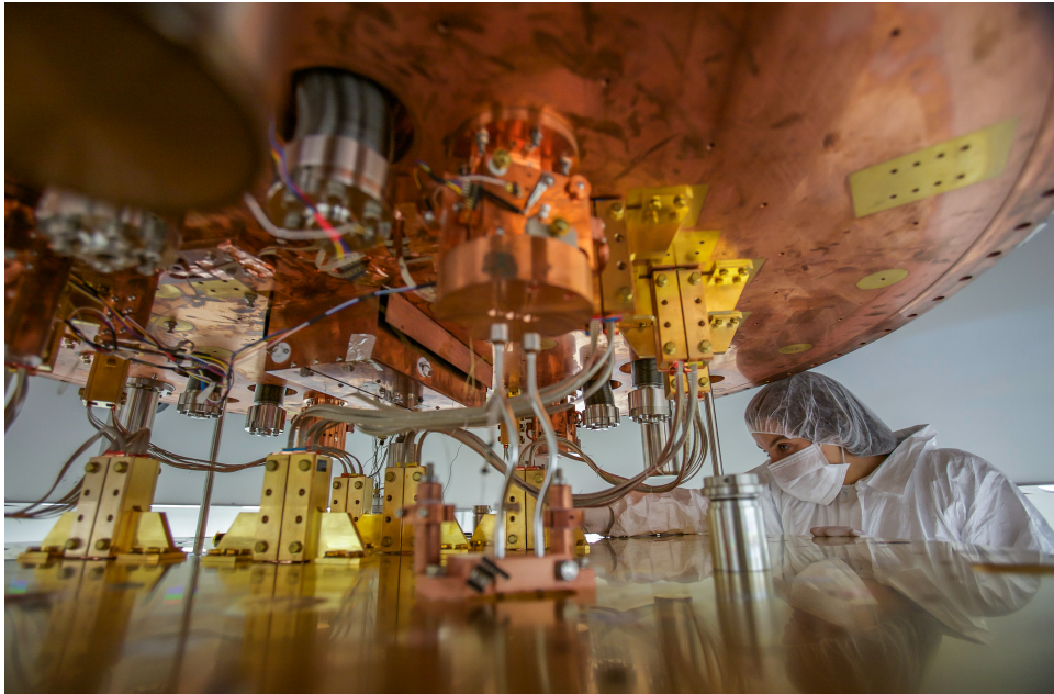
Fig. 6.1.2 Il criostato di Cuore durante l'assemblaggio dell'esperimento.
